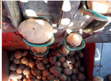
herausgeholt, um aufzuwärmen und die Keimruhe zu beenden. Bei der Pflanzung werden mit der „Pflanzmaschine“ Furchen gezogen, in die Dünger gelegt wird. Darauf kommt ein wenig Erde und darauf die Kartoffel, die beim Fallen aus der Maschine gebeizt wird. Durch dieses Verfahren ist der Dünger nahe an der Kartoffel-
