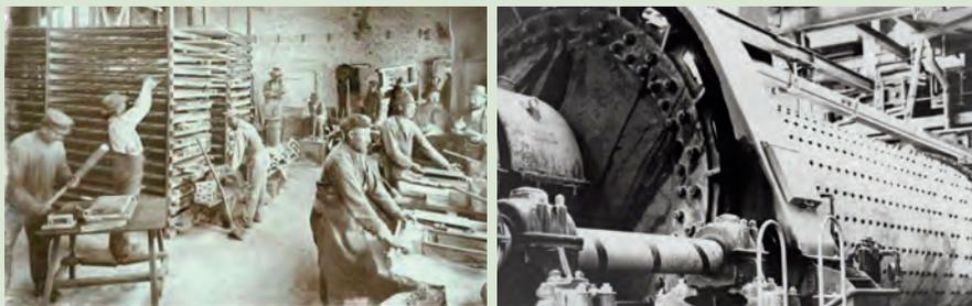
Arbeiter beim Mahlen der Kreide. Mit der zunehmenden Technisierung kamen dann Mahltrommeln zum Einsatz.
